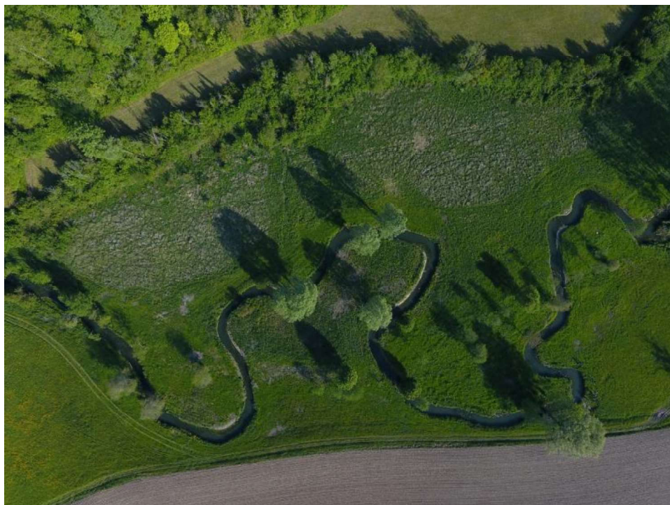
Exemple de reméandrage d'un cours d'eau. L'Échandon est une petite rivière d'Indre-et-Loire (source : OFB, 2021).
